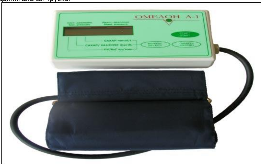
Рис. 1 Внешний вид "Неинвазивного глюкометра и автоматического тонометра Омелон А-1". Панель управления тоноглюкометра размещается на измерительном блоке. Внешний вид панели показан на рисунке 2.
