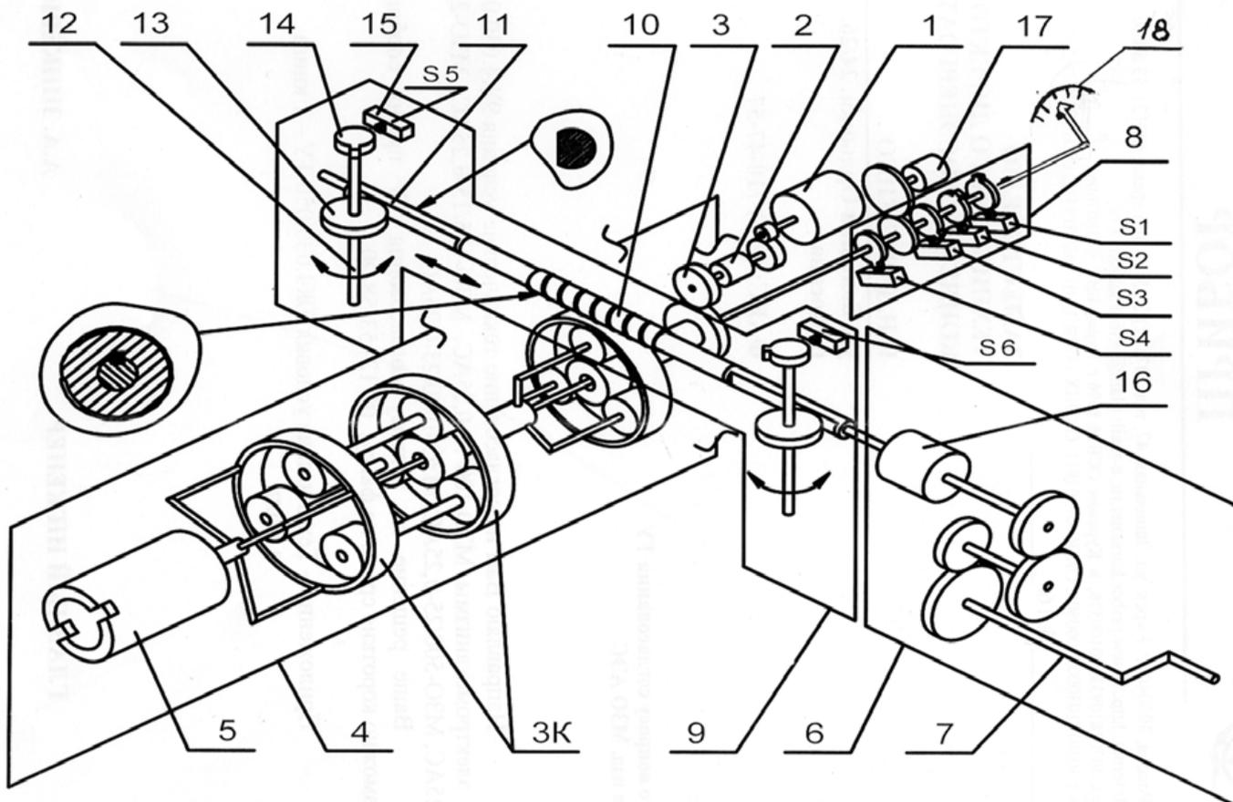
Рисунок 2 - Кинематическая схема механизмов МЭО-500 (1000)/25-0,25АС
