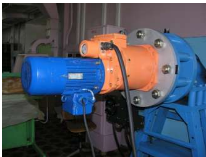
Электромеханизм МЭО-4400/15-0,333 установлен на нагрузочный стенд
