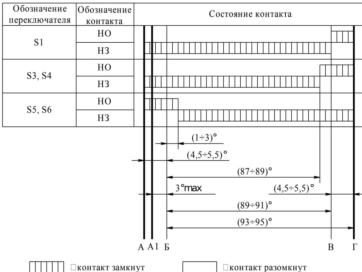
А, Г – внутренние механические упоры механизма
