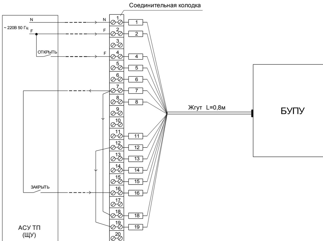
Рисунок 4. Подключение блока БУПУ при питании по варианту 1
