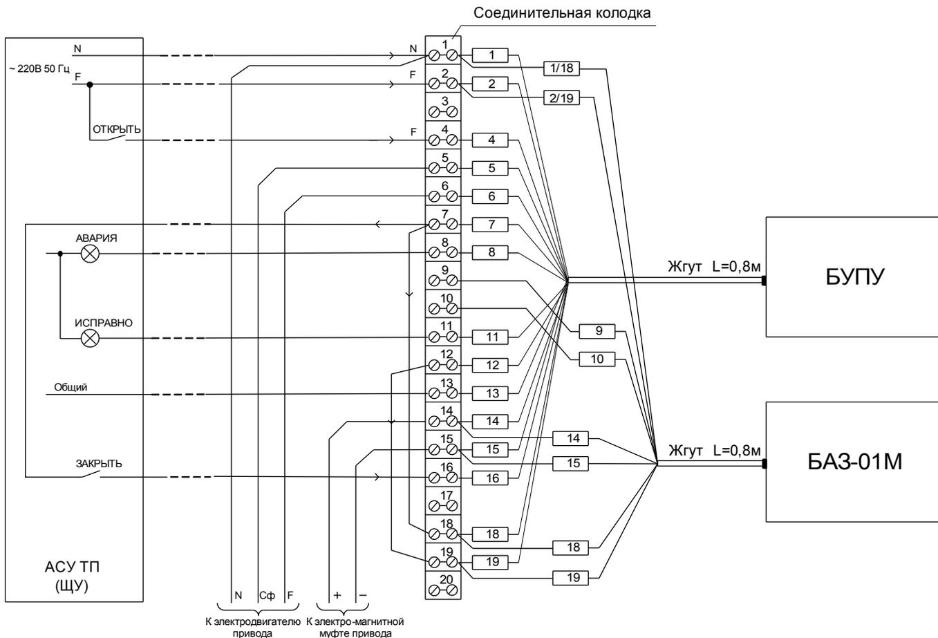
Рисунок 8. Подключение с блоком БА3-01М (вариант)
