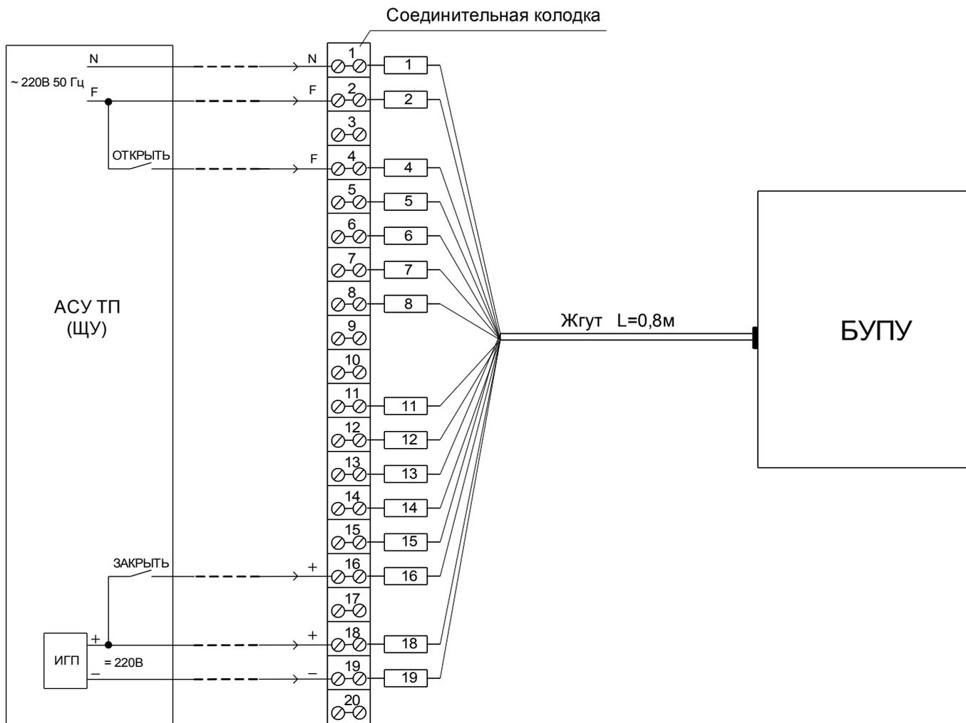
Рисунок 5. Подключение блока БУПУ при питании по варианту 2
