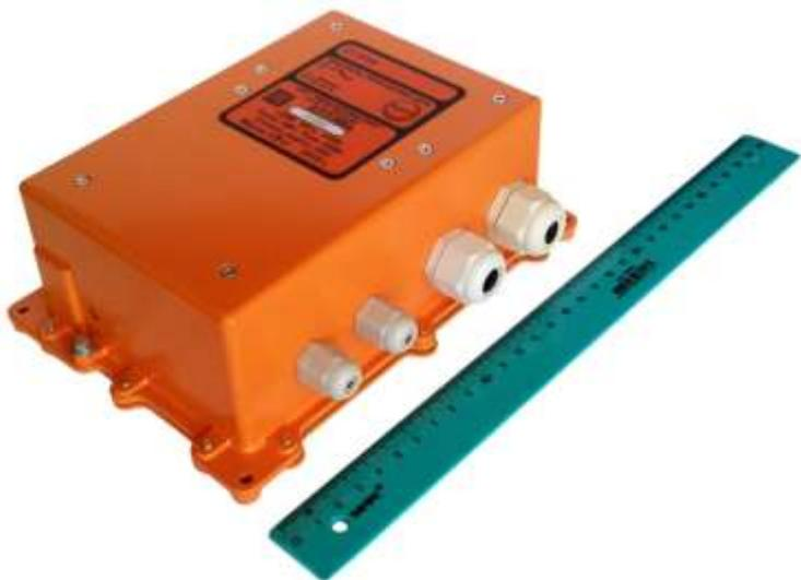
Блок управления БУП-МЦ предназначен для приёма команд управления по каналу RS-485 и организации их исполнения быстрозапорным однооборотным электромеханизмом, а также обеспечения автоматического закрытия арматуры в случае пропадания напряжения сети переменного или постоянного тока.
